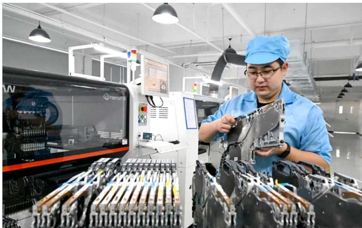
技术人员正在对用于航天激光通讯领域的精密器材快反镜进行堆料
